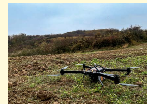
Die Drohne, die am Dernberg zum Einsatz kam, ist mit einem Laserscanner ausgestattet.
